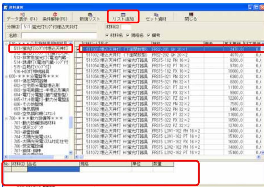
下部のリストに選択した資材が表示されます。同時に拾い出すものがあれば、同じように資材を選択し、『リスト追加』をクリックします。
