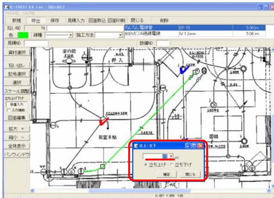
該当箇所でクリックします。立ち上げ・立ち下げ マークが表示され、数量が選択した資材に加算されます。
