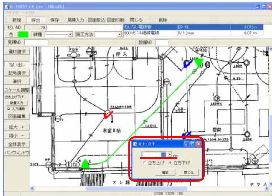
終点（右クリック）でも『立上・立下』画面が表示されますので、数量・立ち上げ・立ち下げを選択し、『確定』か『閉じる』をクリックします。
